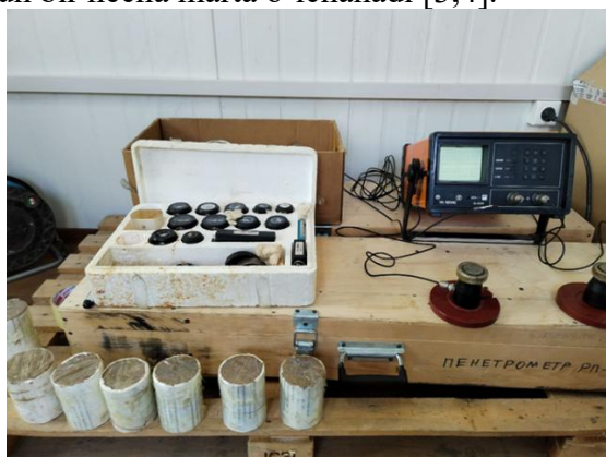
2-rasm. UK-10PMS defektoskopning ishchi holati va UK-10PMS defektoskopning texnik xususiyatlari.
