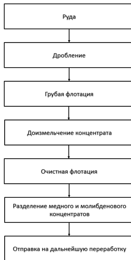
Рис. 4. Пример технологической схемы коллективной флотации медно-молибденового концентрата.
