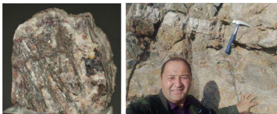
11-rasm. Vismutinni ignasimon kristallari bornit Cu 5 FeS 4 (qora rangda) bilan.
