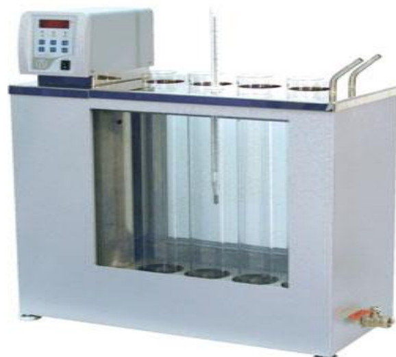
Рис.1. Термостат LOIP LT-810 для поддержания заданной температуры при определении плотности нефти по ГОСТ 3900-2022.
