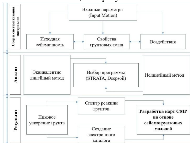
Рис. 1. Алгоритм действий разработки сейсмогрунтовых моделей.
