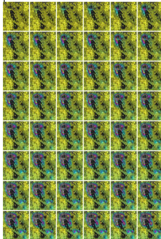
Рис.2. График временных рядов деформации в районе месторождения Хондиза.
