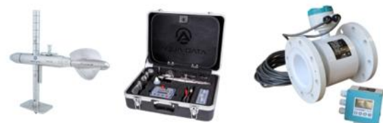
a) Universal Muline (CM-32) markali gidrometrik vertushka b) Elektro magnet oqim oʻlchash qurilmasi
