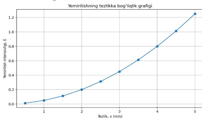
2-rasm. Suyuqlik tezligining yemirilish intensivligiga bogʻliqligi.
