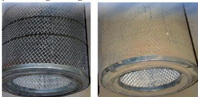
2-rasm. Karyer avtosamosvalining havo filtrining ifloslanish darajasi.
