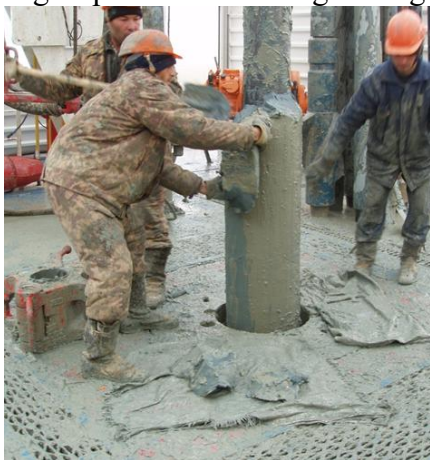
1-rasm. Burg‘ilash tizmasida sallnik hosil bo‘lishi.
