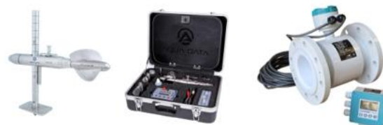
a) Universal Muline (CM-32) markali gidrometrik vertushka b) Elektro magnit oqim oʻlchash qurilmasi
