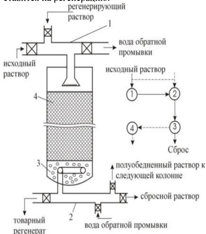
Рис.2. Ионообменная колонна периодического действия:
