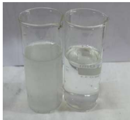
3-rasm. Vinilxlorid monomeri ishlab chiqarish sexining texnologik eritmalarini tindirishdan oldingi va keyingi ko'rinishi.
