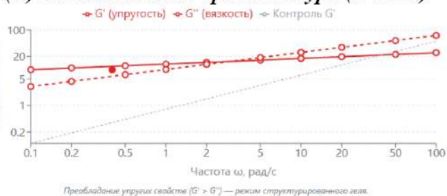
Рис.2. Зависимость динамических модулей упругости ( G' ) и вязкости ( G'' ) от частоты.
