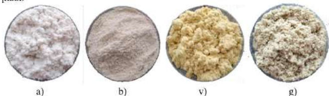
1-rasm. Taklif etilgan texnologiyaga ko'ra ishlov berilgandan so'ng selluloza tarkibli materiallar, bunda termo-fizik-kimyoviy faollashtirish qurilmasi sifatida planetar-valikli ekstruder qo'llanilgan:
