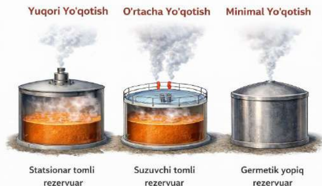
2-rasm. Tuzilishiga ko‘ra farqlanuvchi rezervuarlarda benzinning bug‘lanish orqali yo‘qotilishi.
