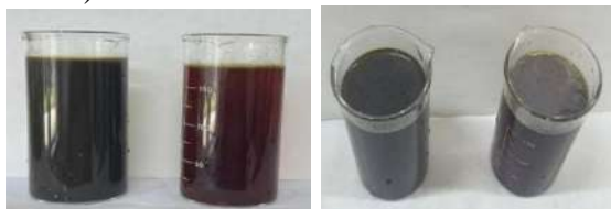
1-rasm. Tiomochevina ishlab chiqarish chiqindi eritmasining tindirish va filtrlashdan oldingi va keyingi ko'rinishi.
