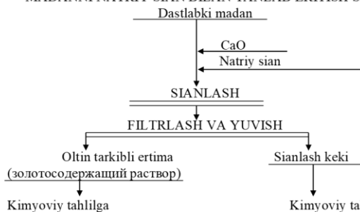
1-rasm. Ma'dan dastlabki namunasini turlik yirikliklarda va turli vaqt oraliqlarida, turli NaCN sarflarida tanlab eritish sxemasi.
