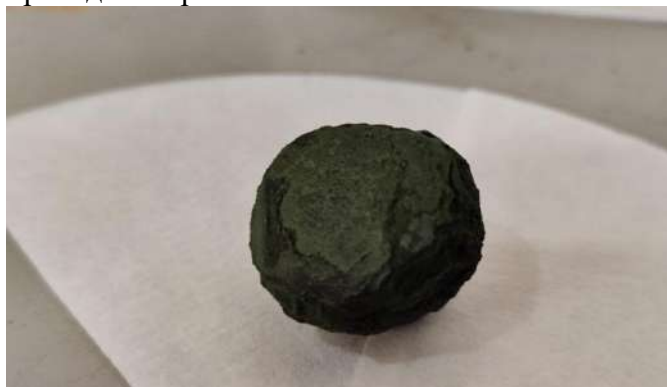
Рис.1. Клинкер из опытной сырьевой смеси, обожжённый при 1380 °С.
