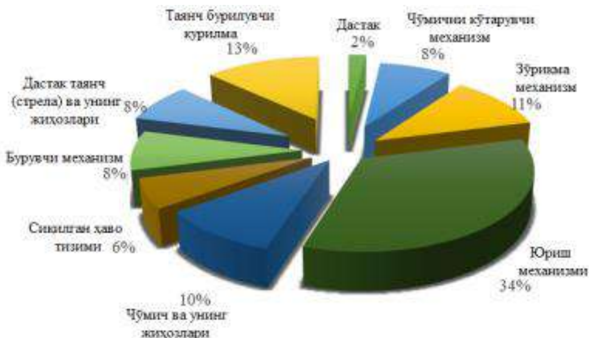
2-rasm. Po‘lat sim arqonli ekskavator mexanik qismlari ishdan chiqishi orqali to‘xtab qolishlarning vaqt birligida taqsimoti
