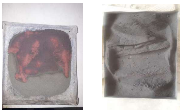
1-rasm. Pirit kuyindisining kuydirishdan oldingi va keyingi holati
