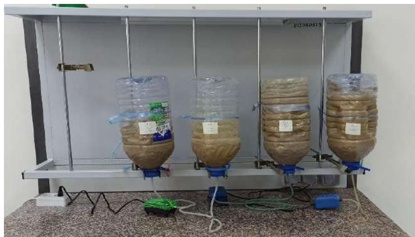
Рис. 2. Лабораторный реактор, подобный аэротенку установки биохимической очистки.
