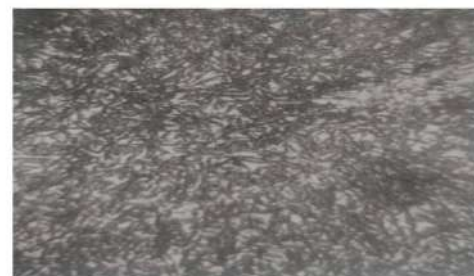
5-rasm. 55XGR markadagi po‘latning sementatsiyalashdan keyingi mikrostrukturasi (x500).
