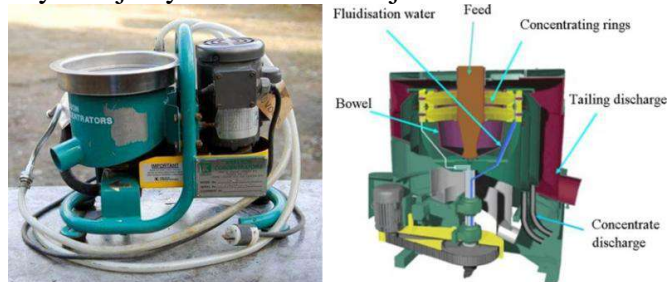
1-rasm. Knelson MD3 markazdan qochirma konsentratiori sxemasi.
