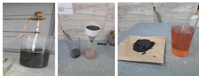
a. Tanlab eritish. b. Filtrlash. d. Co-Ni li eritma va qoldiq kek.
