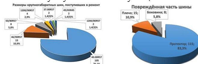
Рис.3. Статистика по крупногабаритным шинам, поступившим в ремонт на Участок шиномонтажа Цеха ремонта автошин УАТ ЦРУ НГМК с сентября 2024 года по июль 2025 года.
