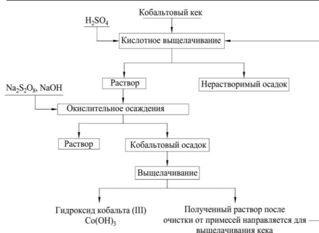
Рис.5. Технологическая схема процесса окисления-осаждения с использованием \text{Na}_2\text{S}_2\text{O}_8 в качестве окислителя.
