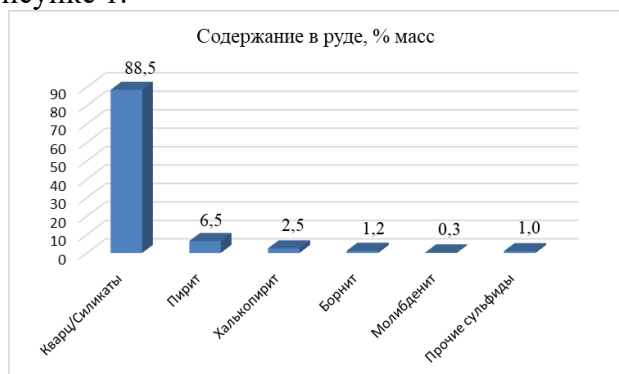
Рис.1. Средний минеральный состав сульфидной медно-порфировой руды.
