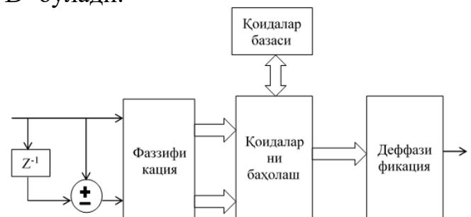
1-расм. Норавшан мантиқ асосидаги бошқариш тизимининг функционал схемаси.
