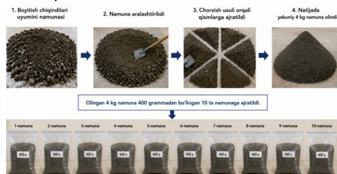
1-rasm. Boyitish chiqindilari namunalarini tayyorlash va qismlarga ajratish sxemasi.
