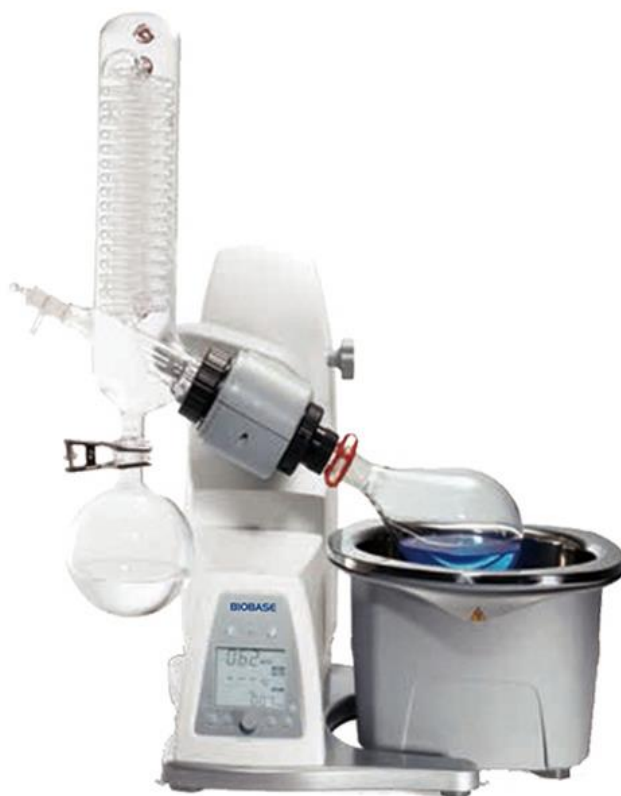
1-rasm. Ko‘pik hosil qiluvchi reagentni sintez qilish uchun tajriba qurilmasi
