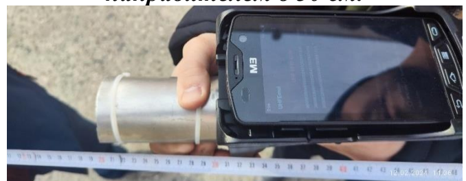
Рис.3. Определение фактора направленности с алюминиевым направителем длиной в 15 см.
