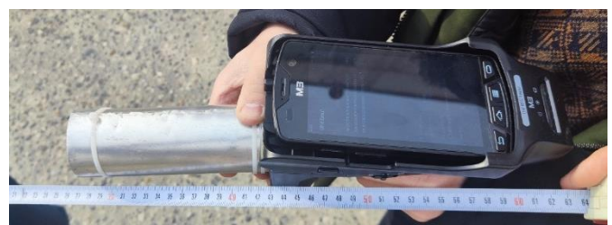
Рис.2. Определение фактора направленности с алюминиевым направителем в 30 см.
