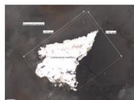
с) Серебрудная минерализация: самородное серебро (56 x 76 мкм) в сростке с нерудным минералом.
