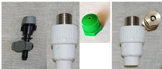
2-rasm. Ozuqa aralashtirish qurilmasiga suyuqlik kiritish purkagichlari.
